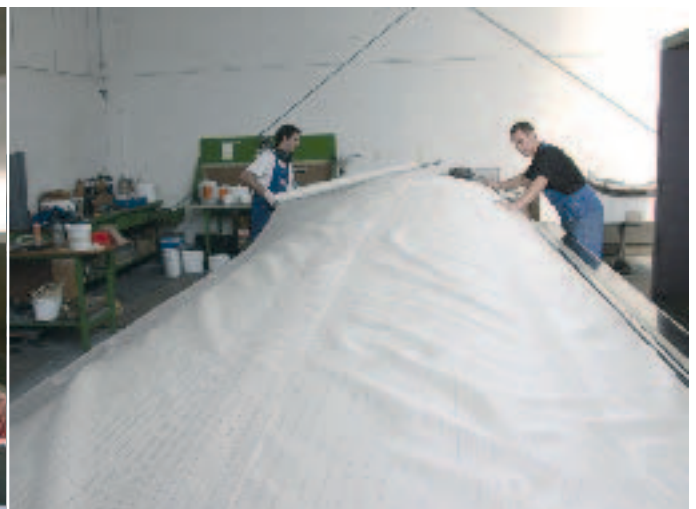
Der Konditor könnte es nicht besser: Wie bei einer Torte entsteht das Innenraumpaneel: Schicht für Schicht...
