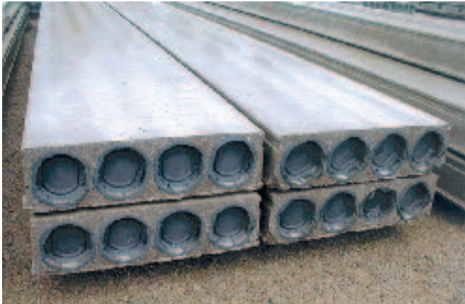
Der Kanal besteht aus Betonfertigteilen mit Leerrohren, in die sämtliche Ver- und Entsorgungsleitungen eingezogen werden können.
