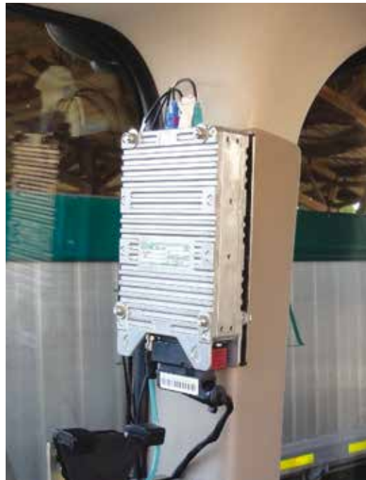
Kleines Kommunikationskraftwerk: das M2M-Modul in der Kabine eines Trackers
