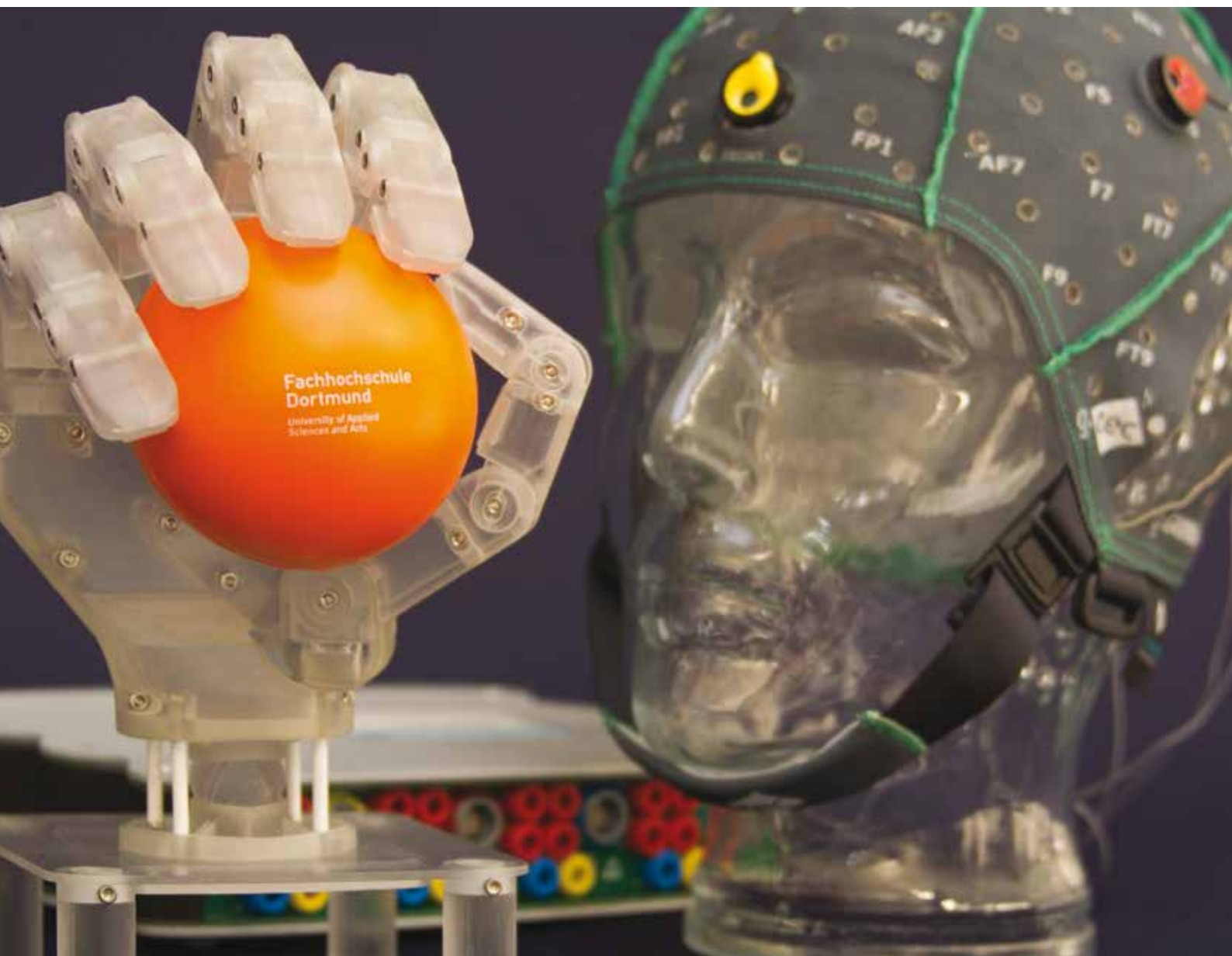
Die Steuerung einer Hand mit Hilfe ausgewerteter Hirnströme; eines Tages, so die Hoffnung, Grundlage für eine neuronal-gesteuerte Prothese
