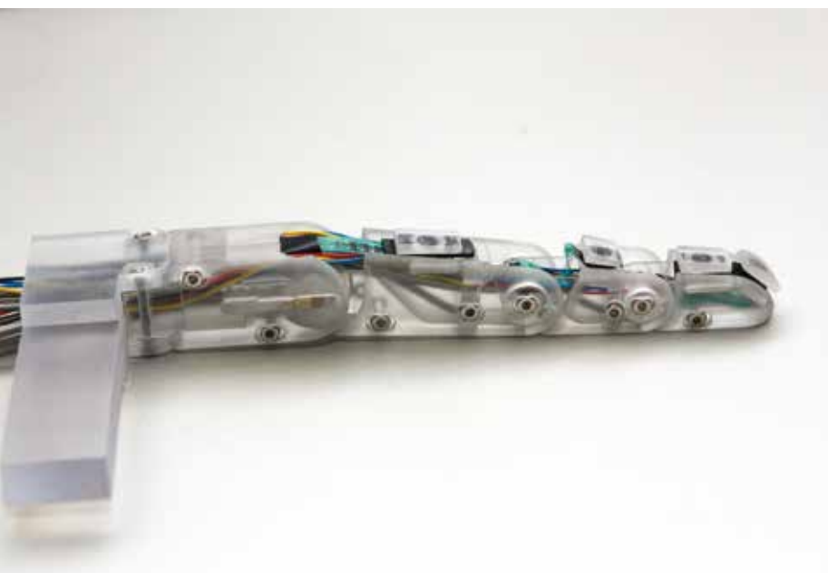
Ein künstlicher, elektronisch gesteuerter Finger mit Drucksensoren und „Sehnen“
