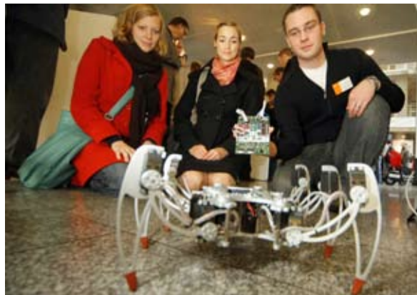
Sechs Spinnenbeine geben die Richtung an: Roboter FRODo kann sich ducken oder über Hindernisse steigen.
