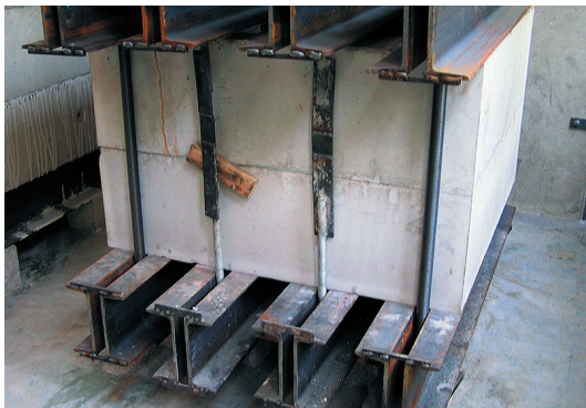
Bild 7: Seitenflächen des Prüfbehälters zum Ende der Prüfung bei maximalem Wasserdruck von 10 bar.
