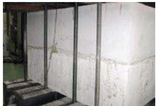
Bild 11: Seitenflächen des Prüfbehälters zum Ende der Prüfung beim maximalen Prüfdruck von 4,0 bar beim Flex 15 Q NB
