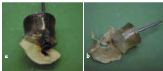
Bild 1: Korrosion an den eingegossenen Stahlstiften, bei denen der Wasserzutritt über das Filterpapier erfolgte (a: Füllgut B, b: Füllgut C)
