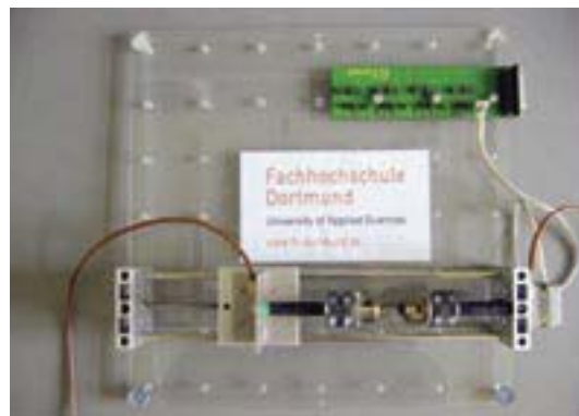
Abb. 3: Der mechanische Aufbau einer einfachen Lichtbogen-Erzeugungseinheit
