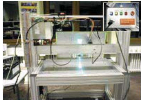
Abb. 7: Technische Ausführung der Lichtbogen-Erzeugungseinheit mit dem Fernbedienungspult
