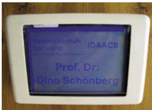
Abb. 5: Prototyp des entwickelten Namensschildes
