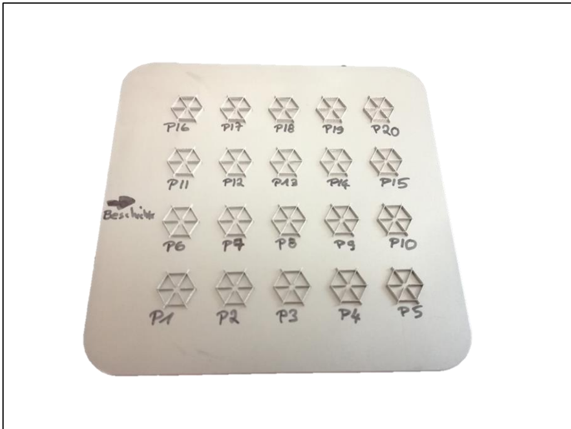
Abb. 55: Bauplatte mit 20 Probekörpern für die Schmelzspurbreite
