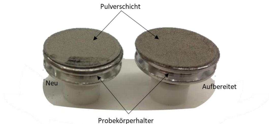
Abb. 36: Probekörperhalter mit aufgetragener Pulverschicht
