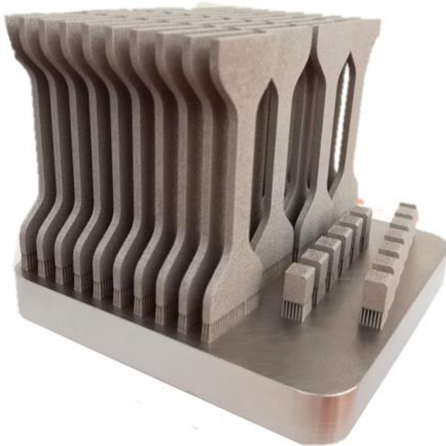
Abb. 35: Gefertigte Zugproben und Dichtequader
