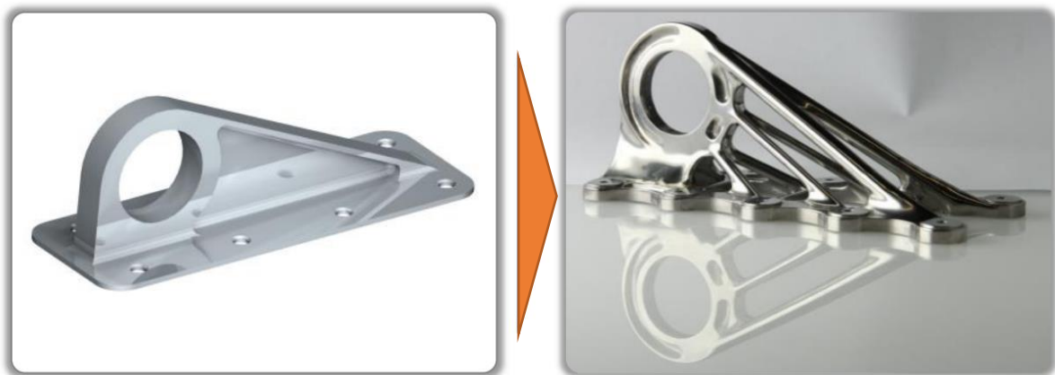
Abb. 16: Beispiel zur Anpassung eines Frästeils für das Selektive Metall-Laserschmelzen (16 S. 59)
