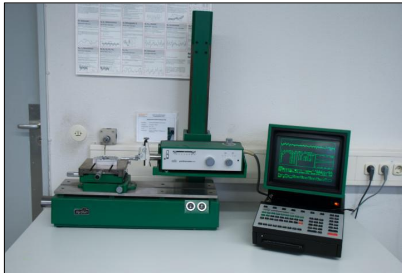
Abb. 29: Oberflächenmessgerät „Perthen Perthometer PRK“ vom Hersteller „Mahr Perthen“; Baujahr 1996
