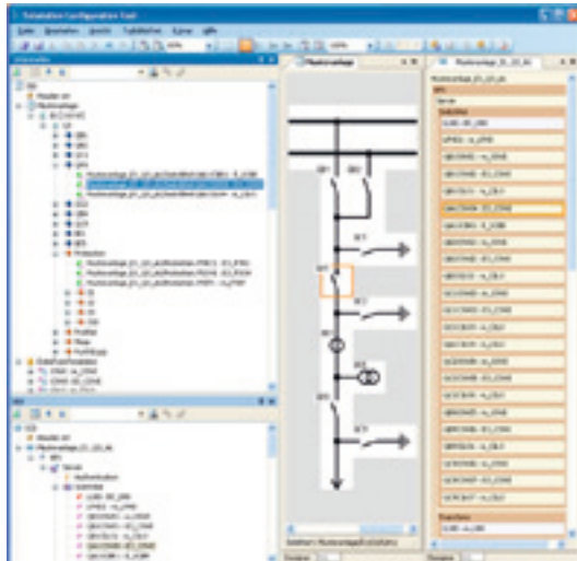
Bild 2: Informationsmodellierung des Abzweigfeldes und Gerätekonfiguration
