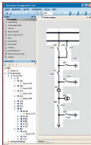
Bild 1: Anlagenprojektierung am Beispiel des Abzweigfeldes einer 110-kV-Schaltanlage
