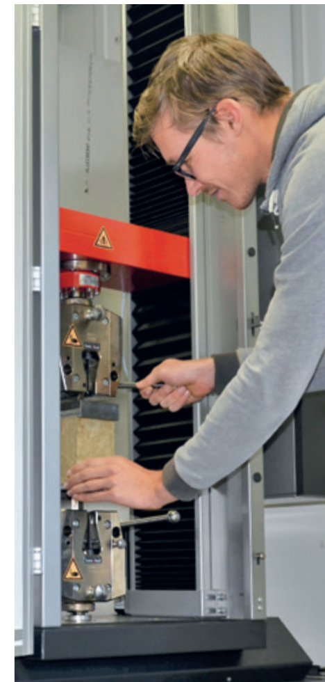
▲ Mit Hilfe der Prüfmaschine führt der Werkstattleiter des Metallabors Daniel Horn den Nachweis der statischen Klebeverbindung eines Probekörpers durch. Foto: Daniela Ridder
