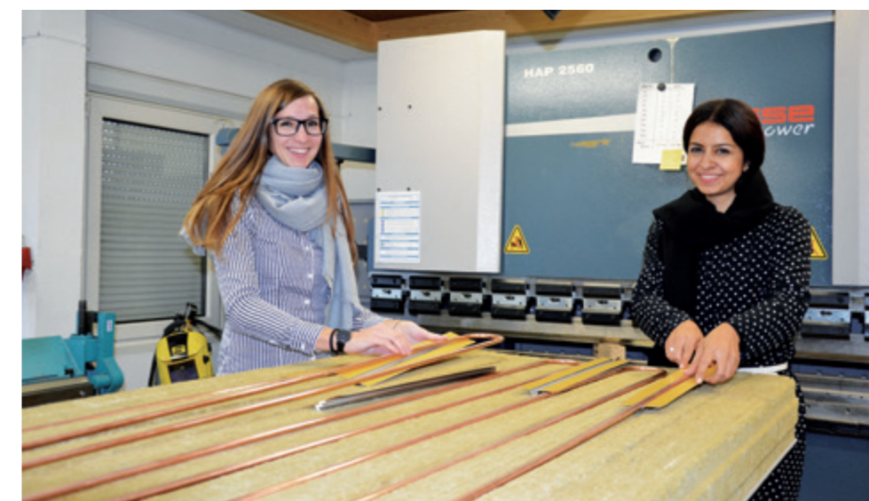
◀ Die Projektleiterinnen Daniela Ridder und Yesim Tekinbas legen das Kupferrohrmäander in die vorgefertigte Fräsung der Mineralwolle des solaren Sandwichmoduls ein. Foto: Thiemo Ebbert
