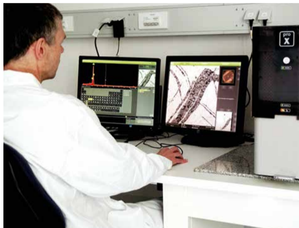
Durch schwingungsgedämpfte Tische für die Mikroskope des Chemielabors werden störende Schwingungen aus der Umgebung isoliert. Foto: Tilman Abegg
