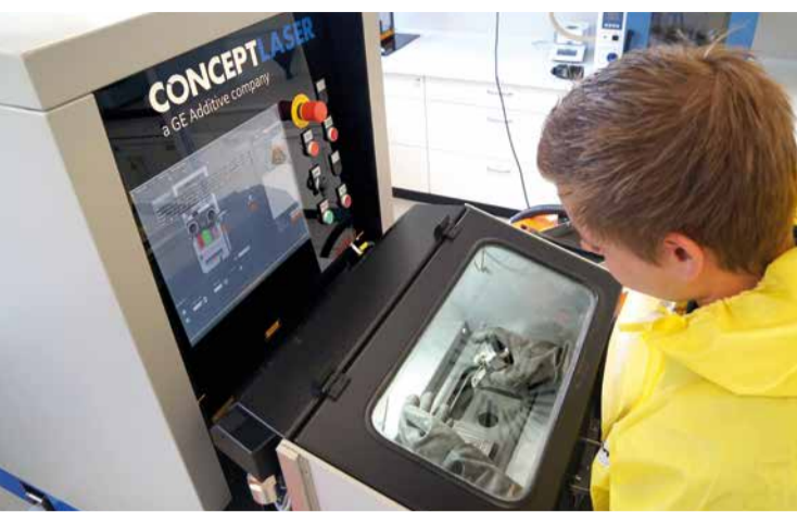
Mit dem 3D-Drucker zum Selektiven Laserschmelzen können individuelle Metallbauteile für viele Einsatzfelder gefertigt werden. Foto: Tilman Abegg
