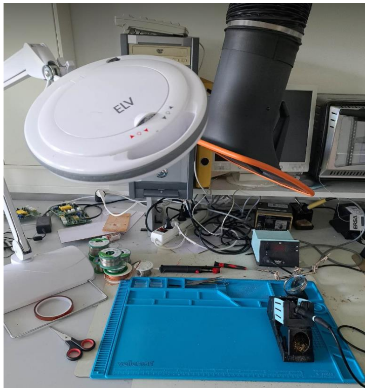
Abbildung 37: Arbeitsplatz für das Handlöten
