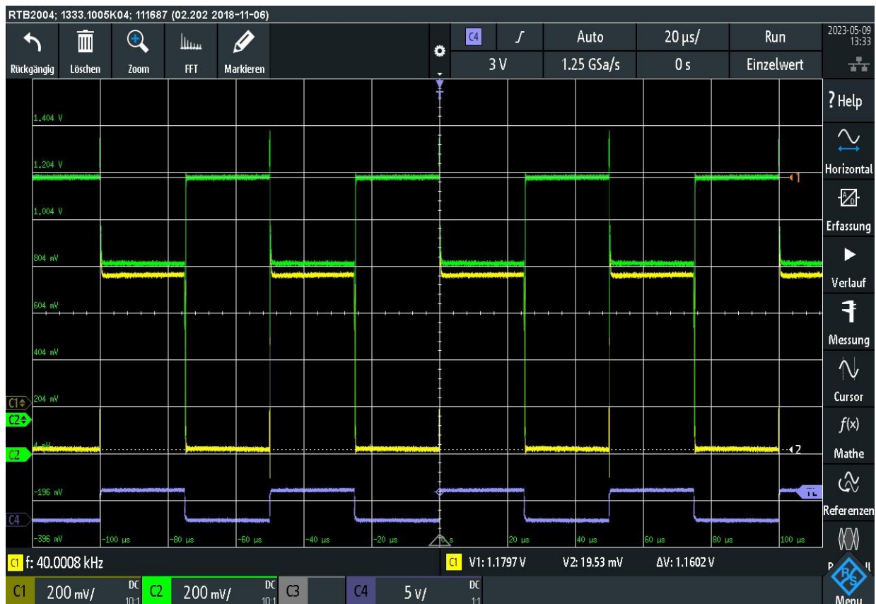
Abbildung 49: CAN-Bus-Zustände des 1,2 V CAN-Transceivers - CANH: Grün; CANL: Gelb; 20 kHz-TX-Signal: Blau;
