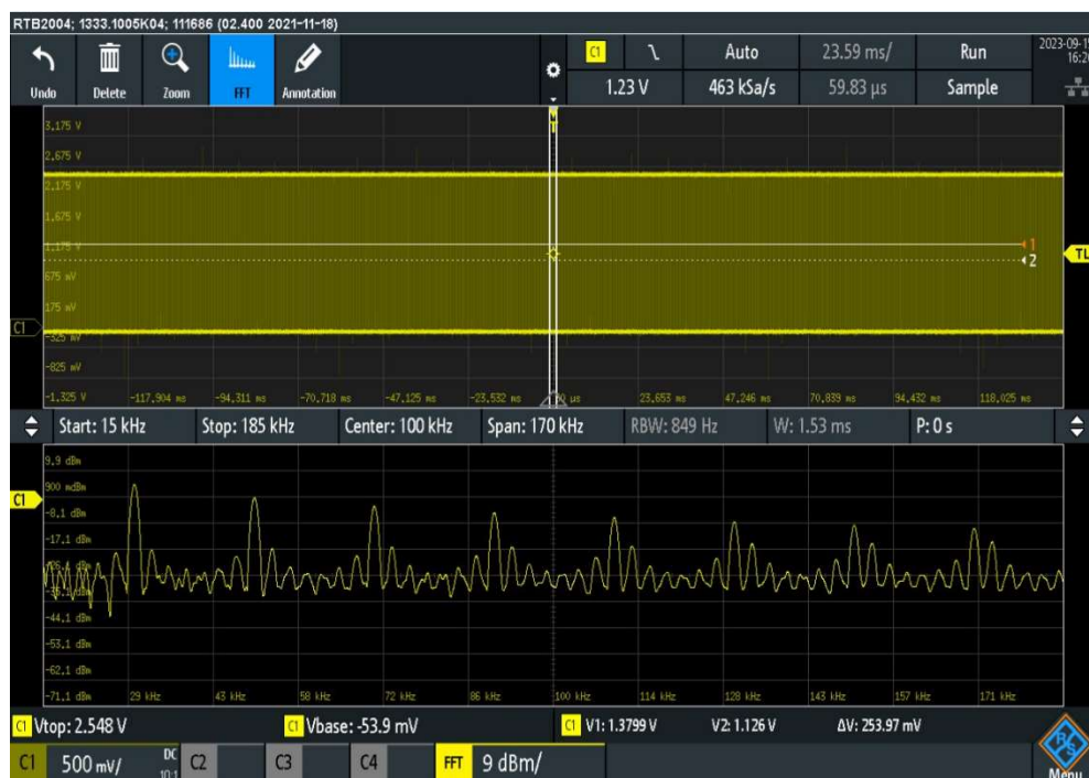
Abbildung 7: FFT-Spektrum eines Rechtecksignal
