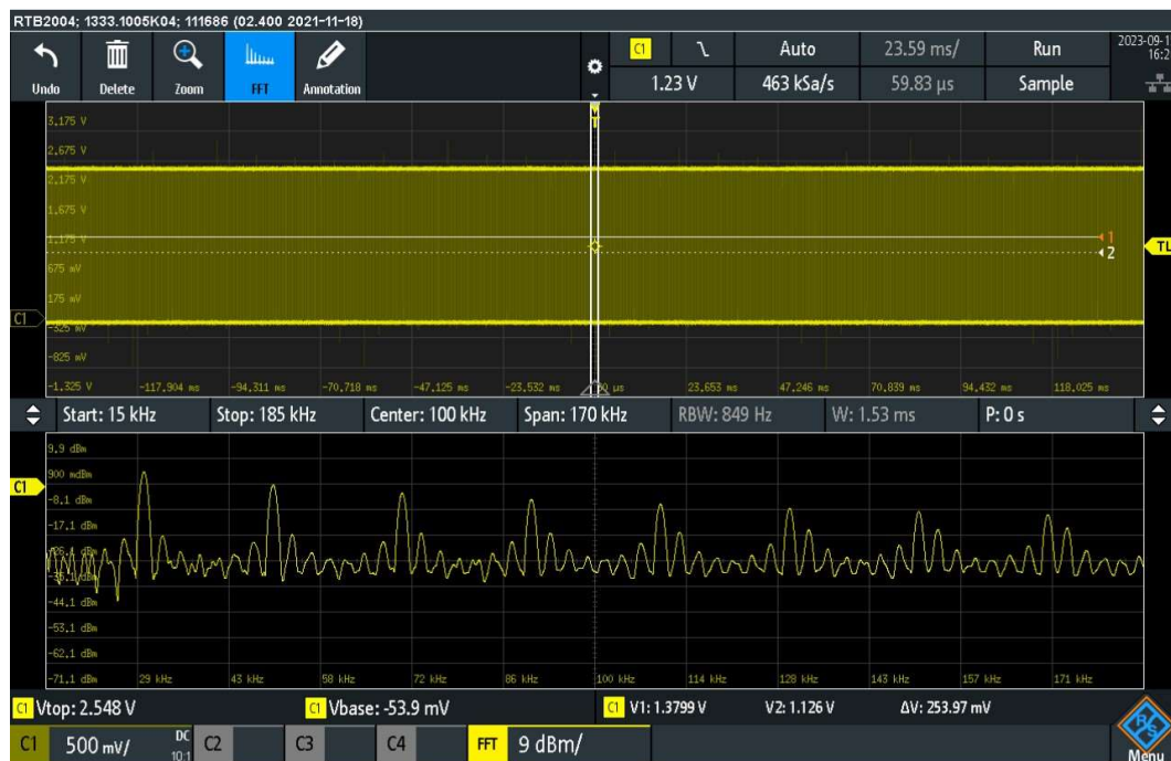
Abbildung 13: FFT-Spektrum mit Frequenzeinstellungen
