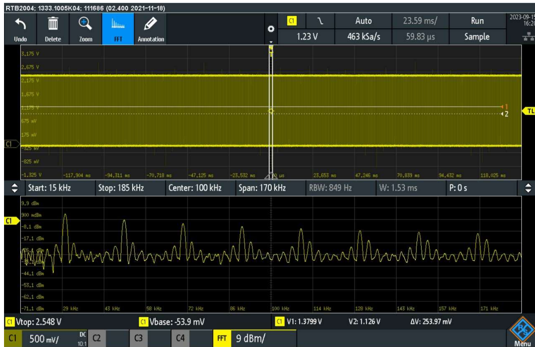
Abbildung 15: FFT-Spektrum mit Frequenzeinstellungen
