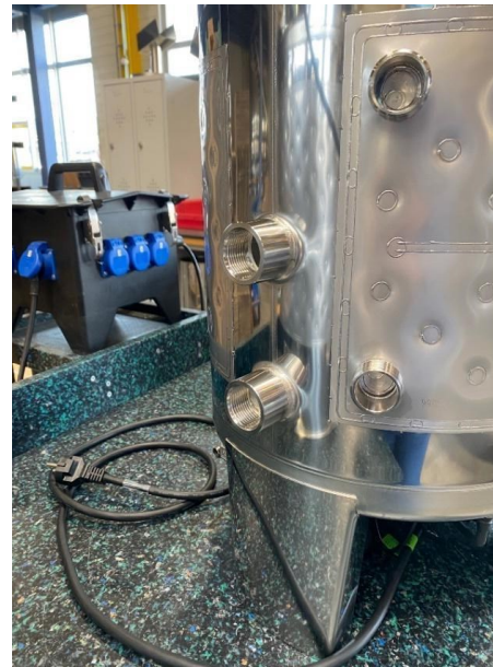
Abbildung 2: Zwei Ein-Zoll-Einschraubstutzen für Drucksensoren
