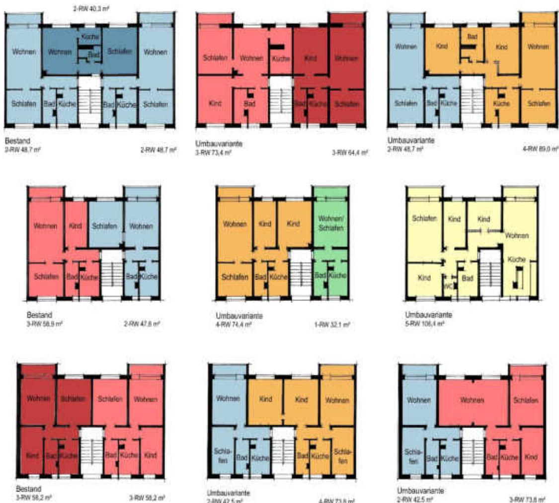
links: Bestandsgrundrisse Mitte und rechts: Umbauvarianten (grün: 1-RW, blau: 2-RW, rot: 3-RW, orange: 4-RW, gelb: 5-RW)
