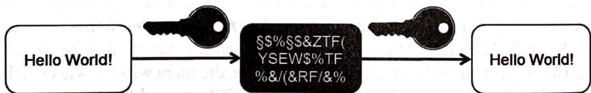
Abb. 4: Schematische Darstellung der symmetrischen Kryptografie 33
