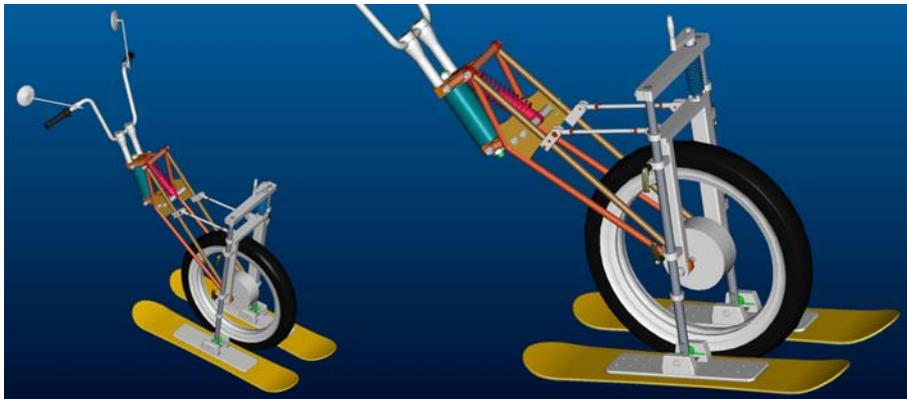
**Bild 7 – CAD Darstellung des verstellbaren Kufensystems – erste Version**
