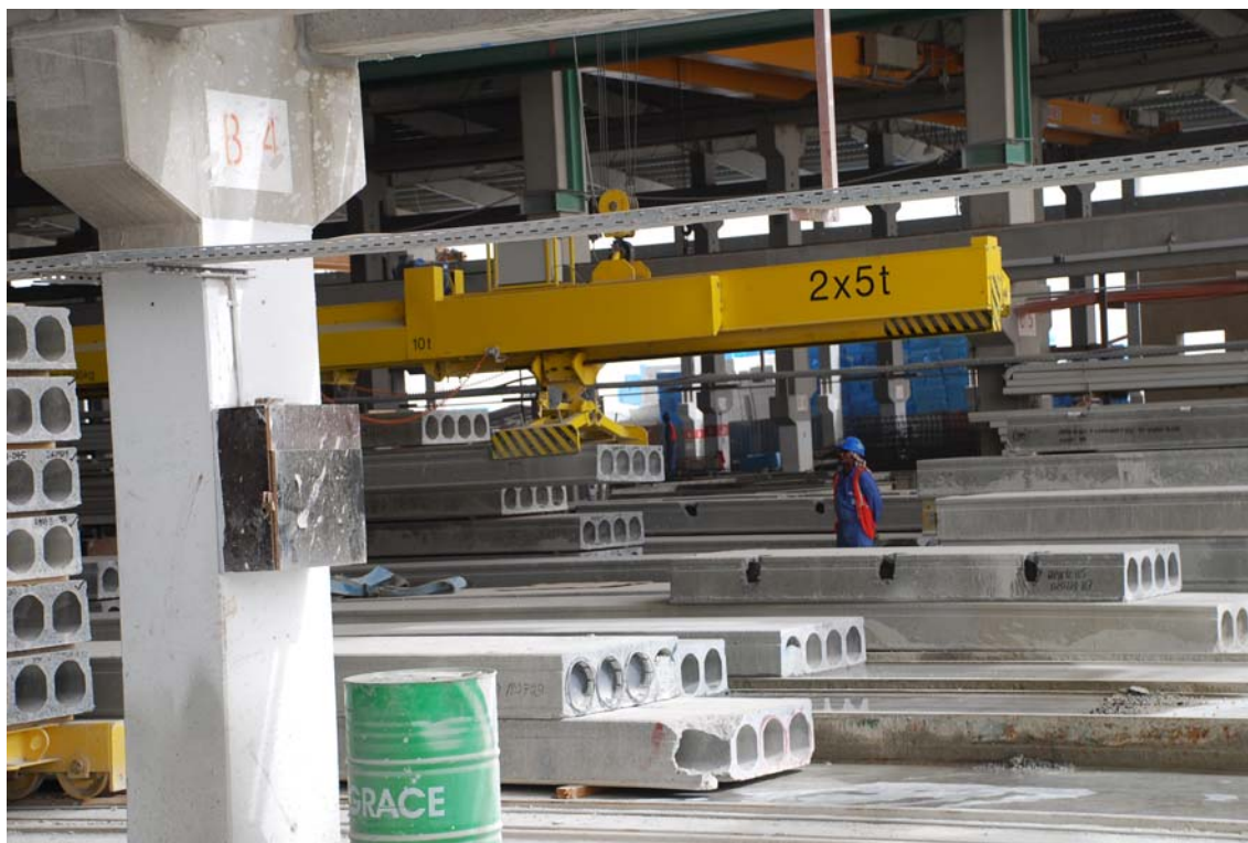
Bild 9: Deckenelemente im Fertigteilwerk (Foto: Philip Scherzinger)
